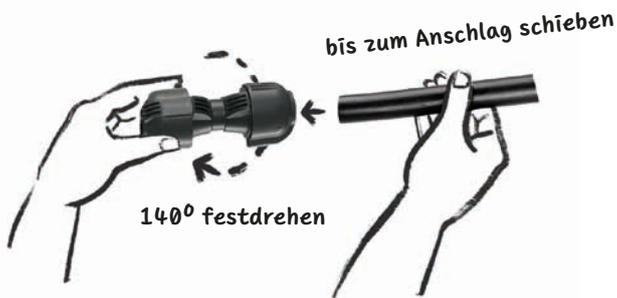
**C** Verbinde jetzt die Elemente. Schiebe die Rohre ca. 6 cm in das Verbindungsteil über den O-Ring. So entsteht eine wasserdichte Verbindung. Vorsicht: Nach ca. 4 cm kommt ein Dichtungsring. Bitte das Rohr an dieser Stelle noch weiter in die Öffnung einführen.
