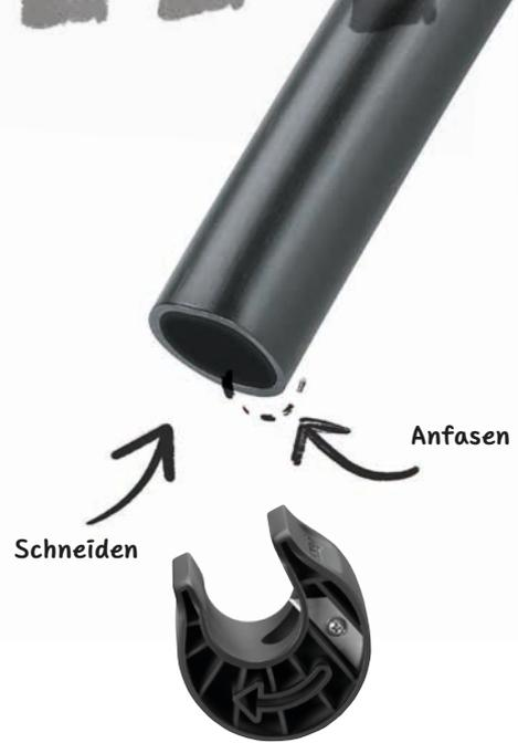
**B** Schneide die Rohre gemäß Plan auf die richtige Länge zu. Achte darauf, dass keine Erde in die Rohrleitung gerät. Falls erforderlich, fase das Rohr an, d. h. entferne unsaubere Schnittkanten. Für gerade Rohrschnitte in nur einer Umdrehung, verwende das GARDENA Schneidwerkzeug für Verlegerohr (Art.-Nr. 2727).
