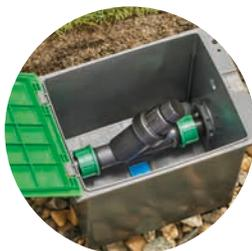
Der Druckminderer schützt das Sprinklersystem vor zu hohem Wasserdruck und kann mit den Sprinklersystemrohren und -anschlüssen kombiniert werden. Der Druck wird bis zu max. 3,1 bar geregelt. Dadurch werden Schäden vermieden und die Lebensdauer des Systems verlängert. Zusätzlich schützt der integrierte Filter vor Verunreinigungen.
