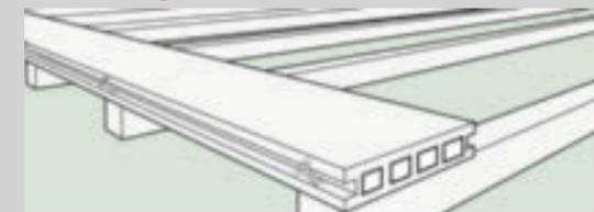
Zu Beginn setzen Sie die erste Diele, beginnen Sie dabei außen auf Anfangsposition der Unterkonstruktion. Aufnahmebohrungen sollten in einem 45°-Winkel zwischen die Nutwangen der Diele zentral in die Unterkonstruktion gesetzt werden. Prüfen Sie, ob das empfohlene Gefälle von 1 % in Längsrichtung eingehalten wurde. Nun verschrauben Sie die Diele.
