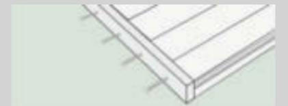
Wenn Sie ein Abschlussprofil montieren wollen, sollten Sie zuerst die Vorbohrung durch das Profil hindurch in die Seite der Diele oder der Unterkonstruktion setzen. So können Sie das Profil anschließend bündig verschrauben.
