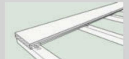
Der Clip verfügt über ein vorgefertigtes Bohrloch. Bohren Sie durch dieses hindurch und befestigen Sie den Clip mit einer Schraube an der Mitte der Unterkonstruktion.
