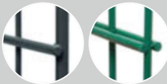
Einstabmatten haben jeweils **einen waagerechten** und **einen senkrechten** Stab (Einstab), die miteinander verschweißt werden. Bei den Doppelstabmatten sind **zwei waagerechte (Doppelstab)** mit einem senkrechten Stahldraht verschweißt. Dadurch sind die Doppelstabmatten stabiler und robuster.
